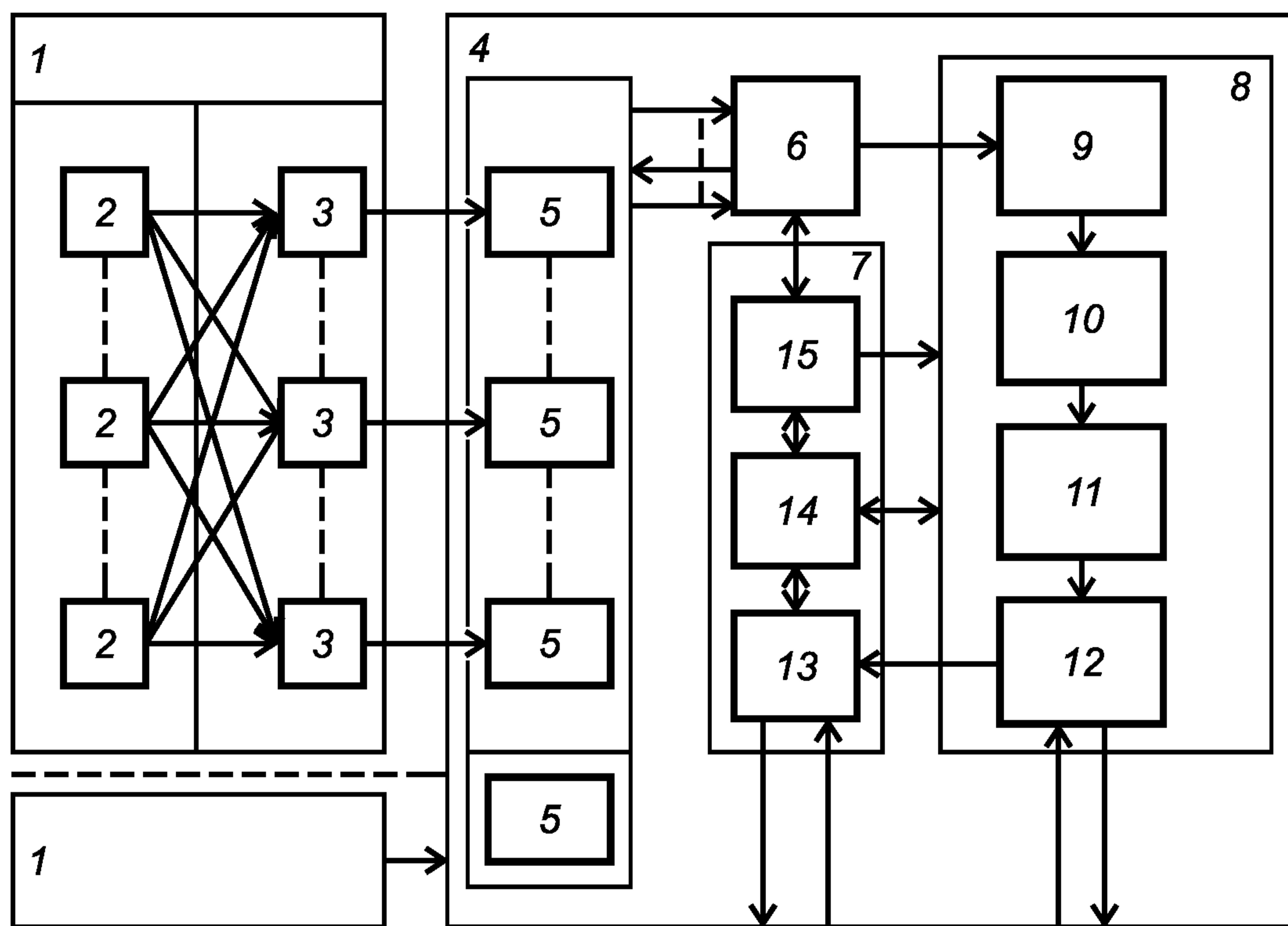
1 — агрегат; 2 — диагностируемый узел; 3 — канал распространения; 4 — система мониторинга; 5 — датчик; 6 — блок согласования; 7 — тракт управления; 8 — тракт распознавания; 9 — анализатор; 10 — блок формирования диагностических признаков; 11 — блок принятия решения; 12 — блок оповещения, отображения и регистрации; 13 — блок сетевых интерфейсов (Intranet/Internet); 14 — информационные базы данных и знаний; 15 — блок управления и синхронизации
